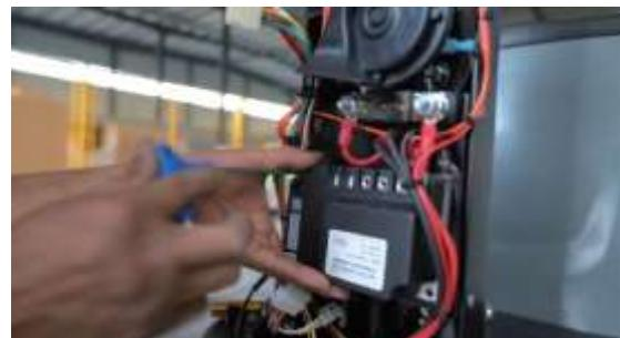
**Примечание:** когда контроллер подключен, положительный и отрицательный провода не должны быть подключены неправильно. Когда машина не работает или не может перемещаться из-за поломки, нажмите вниз рукоятку приводного двигателя, чтобы разблокировать функцию электромагнитного тормоза, который может легко нажиматься.
