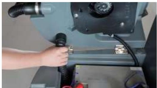
Шаг 3: вставьте коническую горловину всасывающей трубы в отверстие бака для сточных вод, а другой конец трубы – во всасывающее отверстие скребка.
