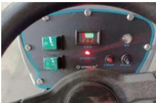
После включения главного переключателя питания дисплей отобразит текущее значение напряжения батареи. Когда напряжение опускается ниже 21 В, пожалуйста, вовремя зарядите батарею.
